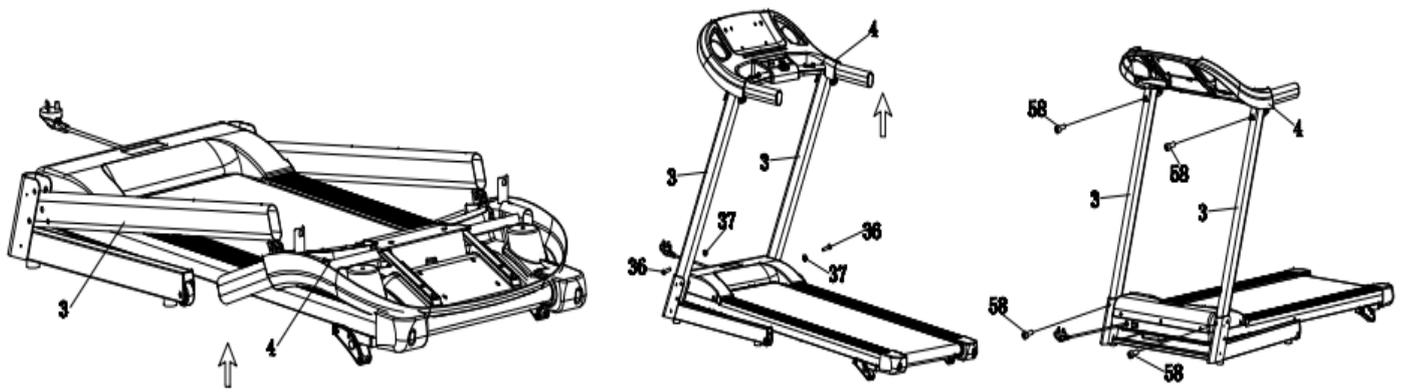
Шаг 3 : Как показано на рисунках ниже: закрепите консоль (№40) на подставке (№4) с помощью крестообразных винтов ST4.2 \* 19 (№44). После этого соедините провода А и В и поместите ключ безопасности (№18) на желтую зону с передней стороны консоли. 5 Затем закрепите левый и правый боковые кожухи (№20R / L) на раме с обеих сторон основания корпуса (№2) с помощью крестообразных винтов ST4.2 \* 19 (№47), как показано на рисунке справа.
