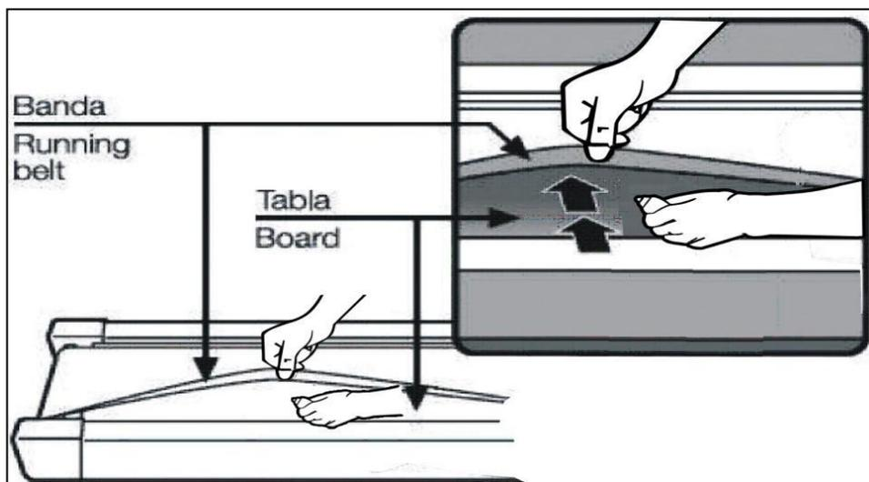
Внутренние части беговой дорожки покрыты смазкой. Трение между бегущей лентой и бегущей дорожкой сильно влияет на срок службы и производительность устройства, поэтому детали должны подвергаться регулярной смазке. Мы рекомендуем регулярно проверять состояние устройства. Если поверхность корпуса повреждена, обратитесь в центр обслуживания клиентов.
