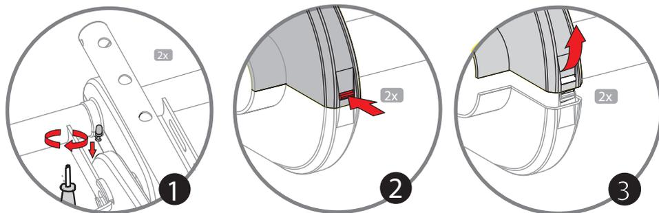
Для регулировки задней цепи, снимите защитный кожух. Ослабьте гайки ступицы. Натяните цепь, двигая привод вперед/назад до нужного натяжения цепи. Цепь натянута правильно, если посередине она может опуститься на 6 мм вниз. См. рис. ниже. Удостоверьтесь, что звездочка привода находится на одной линии со звездочкой задней оси и перекося отсутствует. Снова затяните гайку привода.
