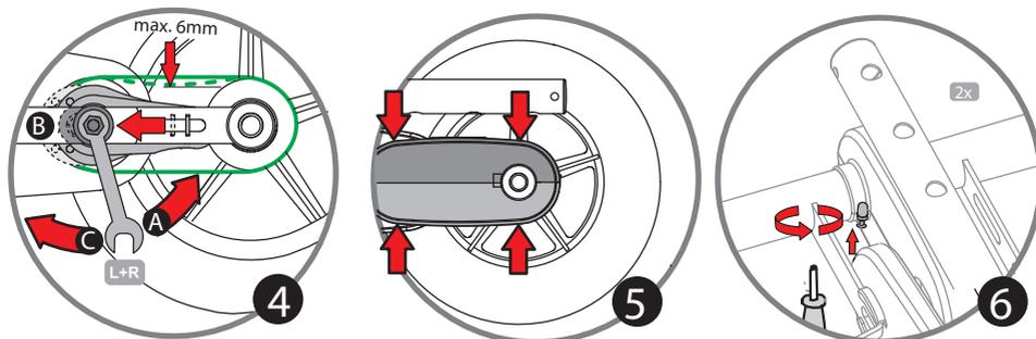
Натяжение передней цепи: снимите большой защитный кожух, ослабьте болты каретки на нижней стороне рамы. Натяните цепь, перемещая каретку с педалями вперед/назад. Затяните болты снова. Цепь натянута правильно, если посередине она может опуститься не более чем на 1 см вниз. Для проверки натяжения цепи достаточно снять нижнюю половину защитного кожуха. См. рис. ниже.
