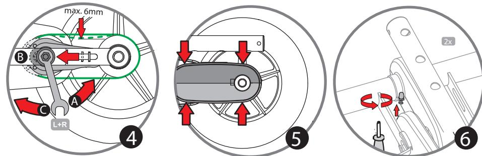
Натяжение передней цепи: снимите большой защитный кожух, ослабьте болты каретки на нижней стороне рамы. Натяните цепь, перемещая каретку с педалями вперед/назад. Затяните болты снова. Цепь натянута правильно, если посередине она может опуститься не более чем на 1 см вниз. Для проверки натяжения цепи достаточно снять нижнюю половину защитного кожуха. См. рис. ниже.
