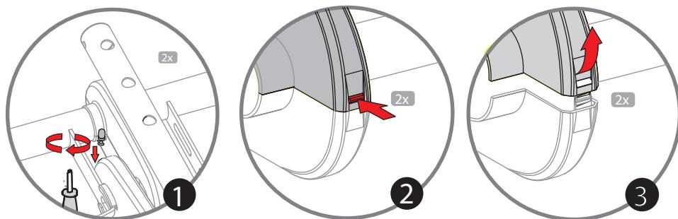
Для регулировки задней цепи, снимите защитный кожух. Ослабьте гайки ступицы. Натяните цепь, двигая привод вперед/назад до нужного натяжения цепи. Цепь натянута правильно, если посередине она может опуститься на 6 мм вниз. См. рис. ниже. Удостоверьтесь, что звездочка привода находится на одной линии со звездочкой задней оси и перекос отсутствует. Снова затяните гайку привода.
